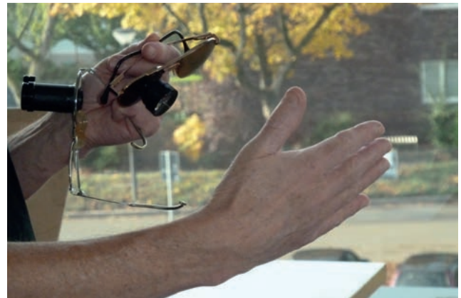
Fernrohrbrille (links) und Lupenbrille (rechts) im direkten Vergleich
